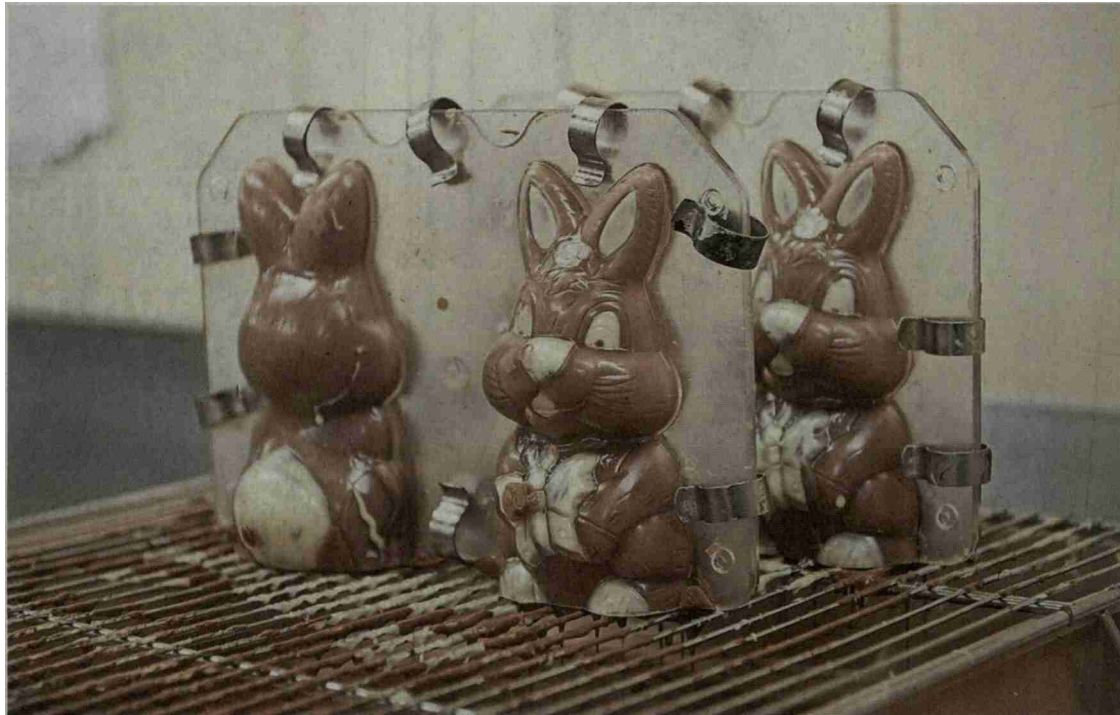
Auf dem Abtropfgitter fließt die nicht haftende Schokolade aus dem Hasen heraus.
